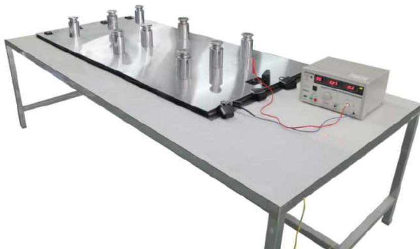
Equipo de medición para la corriente total de fuga en frío
