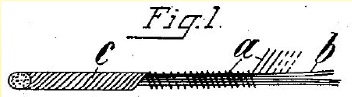
Cable de calefacción (patentado por Camille Herrgott, 1901). A = Cable de calefacción. B = núcleo textil; C = envoltura exterior enrollada en dirección opuesta al cable de calefacción.
