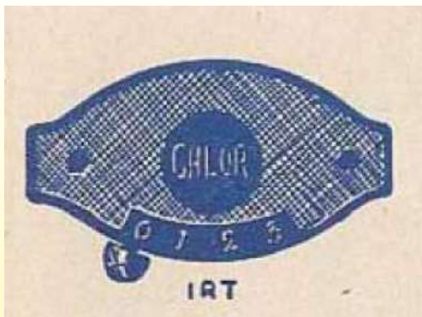
1947 Interruptor con 4 posiciones de ajuste para termoplasmas. Las 4 posiciones luego se convertirían en 5, con una parada en cada lado para evitar errores de posicionamiento por la noche (catálogo de repuestos de Calor, 1947, Museo Ultimheat)
