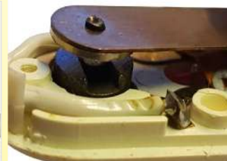
Circa 1972. Caja de control de potencia fabricada por Jidé en Limoges bajo la marca Jidéstat. El más exitoso de todos los sistemas. Muy pequeño en tamaño, es ajustable y se incorpora en el enchufe eléctrico. Es el único modelo con un contacto magnético de cierre rápido. No fue superado por sistemas electromecánicos hasta la era actual. (Colección Ulti- mheat)
