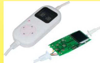
2019 Unidad de control para mantas térmicas con control de temperatura y pantalla digital a través de una sonda termistor incorporada en el área calentada (Colección Ultimheat)
