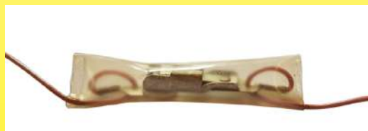
Limitador de temperatura de manta térmica de rotura lenta Calor, calibrado a 80 °C (circa 1960). Nótese la funda impermeable de PVC soldada en los cables y el bucle hecho por los conductores eléctricos que pasan por un agujero en cada terminal, esto es para eliminar tensiones de tracción en el cable (Colección Ultimheat)
