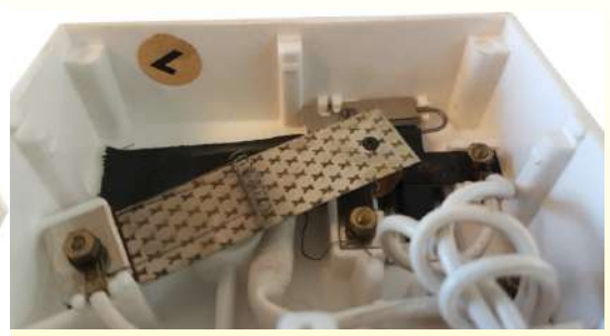
Circa 1970. Ajuste de potencia de GEC (General Electric, Inglaterra) en una manta térmica inglesa. La resistencia anticipada es claramente visible sobre la bimetalica y el interruptor lento (Colección Ultimheat).
