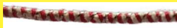
Circa 1960. Cuerda calefactora "autorreguladora" de la marca Ellesert, diámetro 1,2 mm. El núcleo central es un hilo de algodón recto rodeado por una guipur que consta de dos hilos de algodón de 0,1 mm de diámetro enrollados con un paso de 0,8 mm. Luego hay un guipur de conductor de níquel de 3 hilos de 0,067 mm enrollado con un paso de 0,8 mm en la dirección opuesta. Esto evita que toda la unidad se enrede (Colección Ultimheat)
