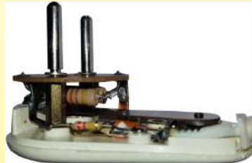
Circa 1972. Caja de control de potencia fabricada por Jidé en Limoges bajo la marca Jidéstat. El más exitoso de todos los sistemas. Muy pequeño en tamaño, es ajustable y se incorpora en el enchufe eléctrico. Es el único modelo con un contacto magnético de cierre rápido. No fue superado por sistemas electromecánicos hasta la era actual. (Colección Ulti- mheat)
