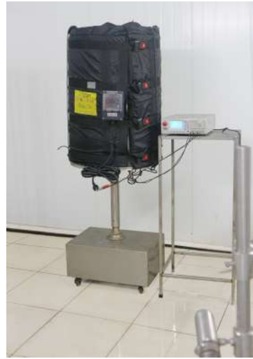
Medición de la resistencia de aislamiento después de las pruebas IPx6
