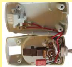
1995: Una manta térmica con medidor de potencia estadounidense, similar a la desarrollada más de 50 años antes por Cook en 1942. Vista exterior y vista de la bimetalica interna con un interruptor lento y resistencia anticipada. La única novedad en este modelo es que incluye un filtro de ruido (Colección Ultimheat)
