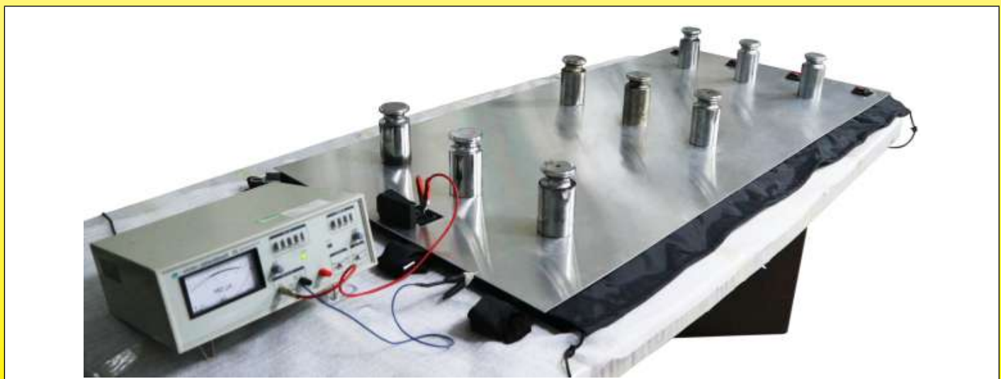
Dispositivo para medir la resistencia de aislamiento. Los valores medidos son siempre mayores a 0,1 Gohmios
